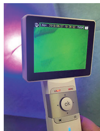
● 図2 撮影時：レンズの周囲から青色光が照射される。ディスプレイでは青緑色が映し出される。手元のボタンで操作し、写真撮影ができる。
